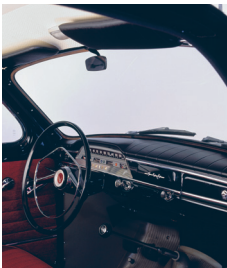
PV544, 1960. Панель приборов с мягкой верхней частью. Нераздельное лобовое стекло и новая панель приборов
